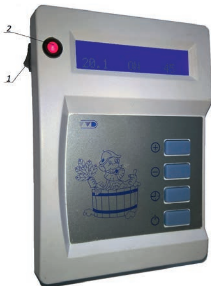
Рис. 6 Пульт управления паротермальной печью «ПремьераРуса» с ЭГПП
